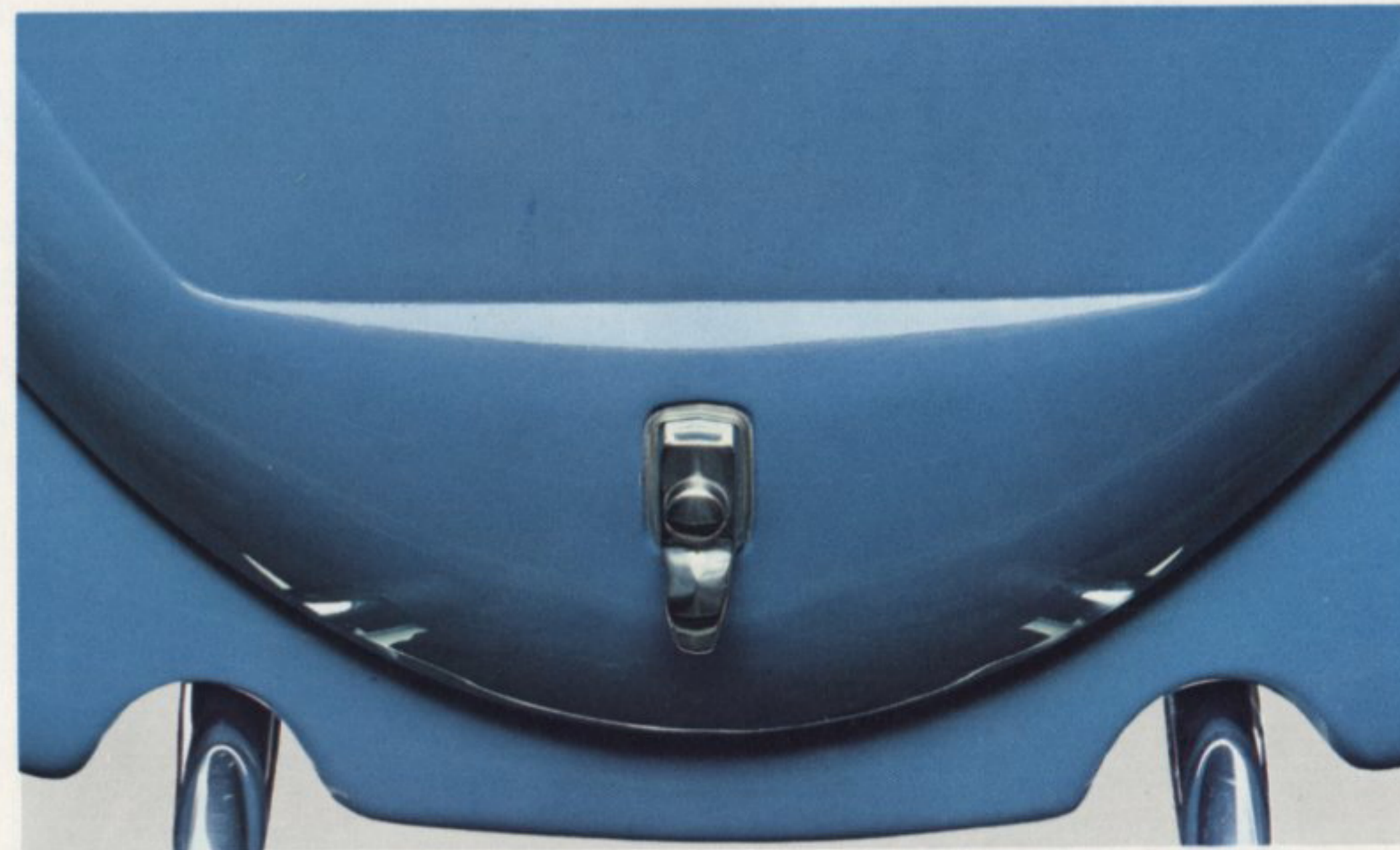
Neuer Druckknopfverschluss für die Motorhaube. Das Schloß rastet beim Schließen der Haube selbsttätig ein.
