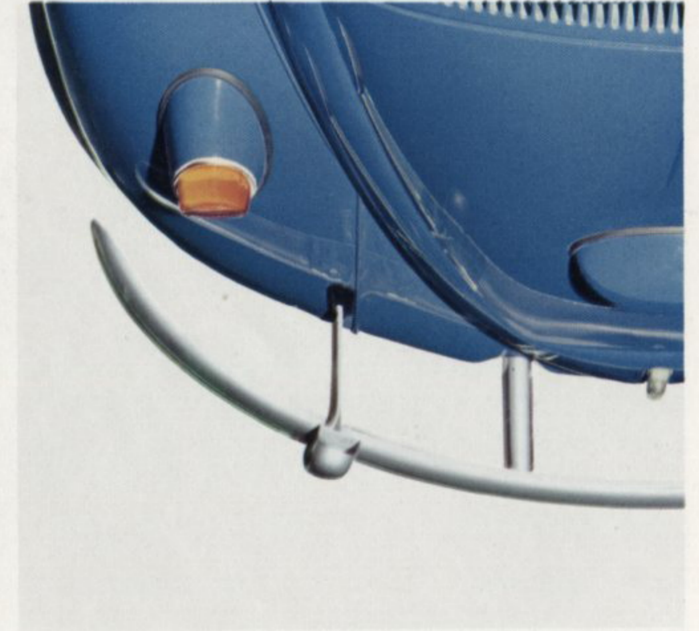
Die Stoßstangen haben genügend Abstand von der Karosserie: Damit sie nachgeben können.
