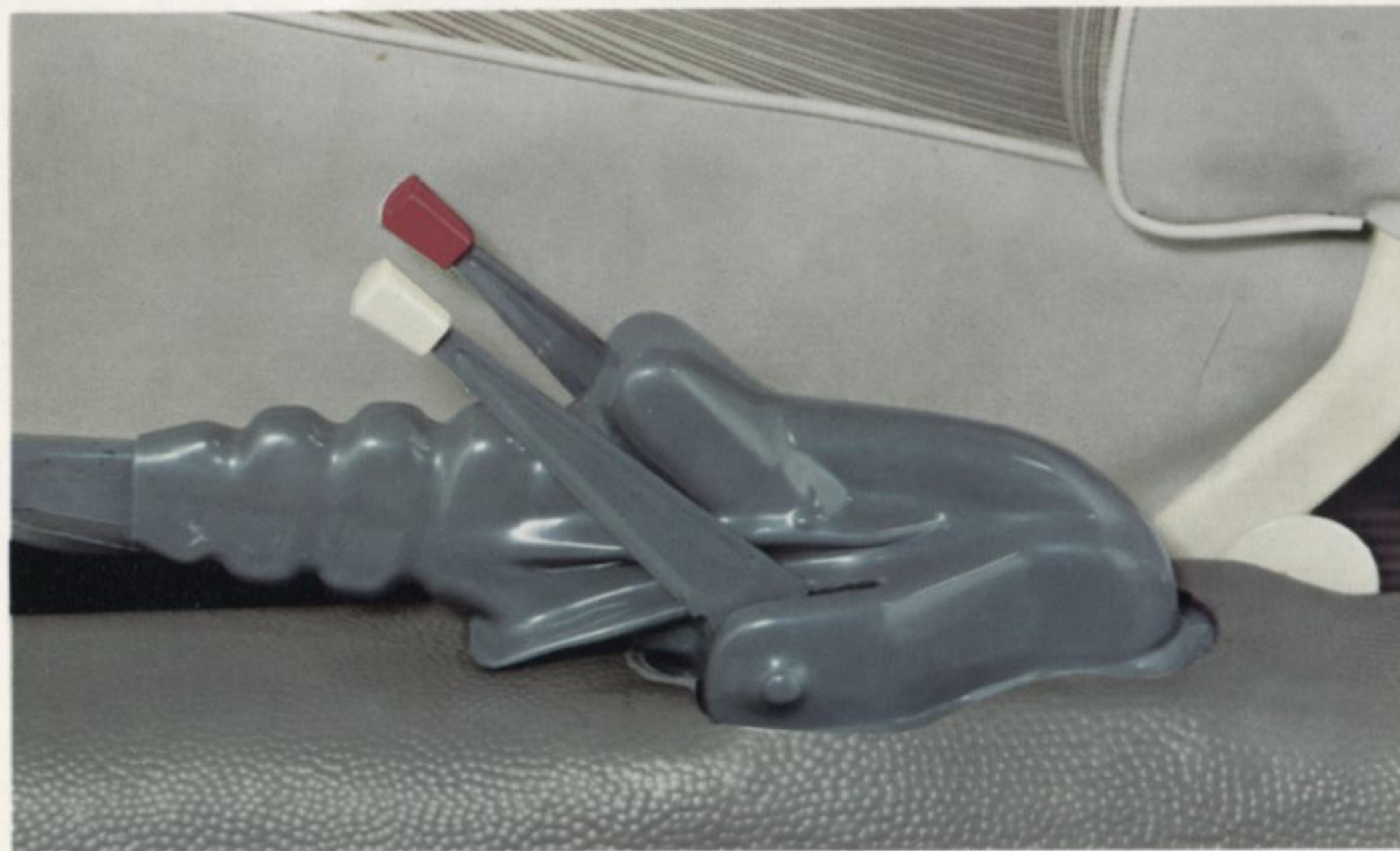
Anstelle des Drehknopfes: Steuerung der Heizung durch einen Hebel. Mit einem zweiten Hebel kann der Fahrer die Heizungsdüsen im Fond regulieren.
