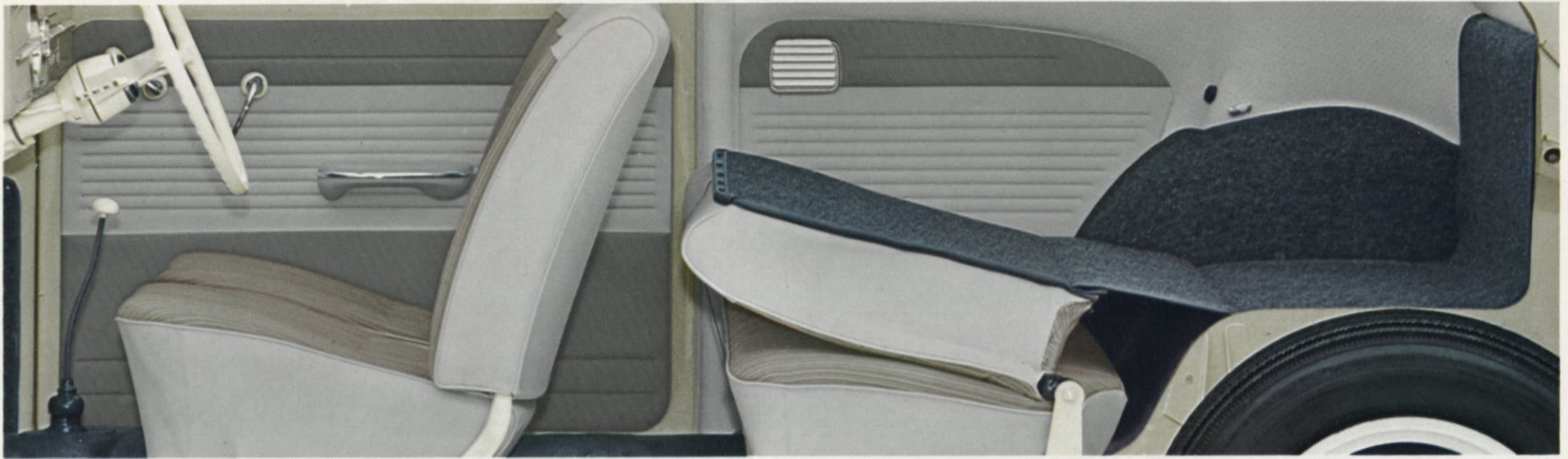
Vergrößerung des hinteren Gepäckraumes (bei Besetzung des Wagens mit 2 Personen) durch umklappbare Rücksitzlehne. Der Gepäckraum verlängert sich bis zur Vorderkante der hinteren Sitzbank. Ein Spannband hält die Lehne fest.
