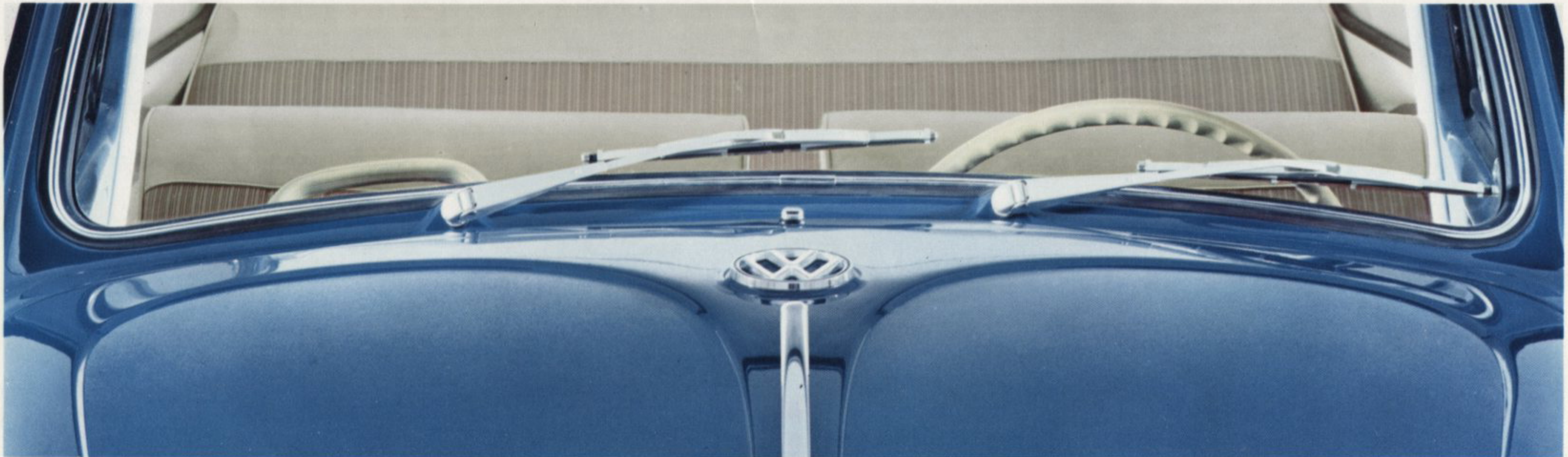
Sichtverbesserung durch neue Scheibenwischer. Die Wischerblätter sind als Gelenkblätter ausgeführt. Sie sind größer geworden und liegen in Ruhelage links. Das gereinigte Blickfeld des Fahrers nach links ist günstiger.
